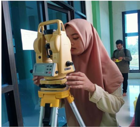
Gambar. 4.5 Menyeimbangkan Kedataran Theodolit, Dengan Memperhatikan Water Pass
